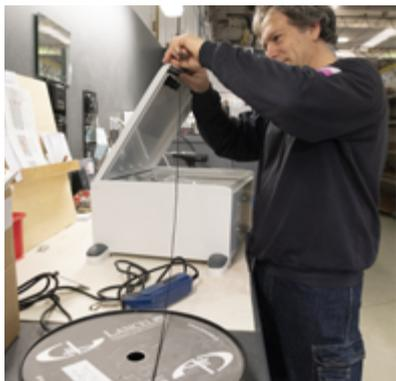
Les Chantiers AMEL livrent à leurs clients des bateaux uniques : finitions, matériaux et équipements - rien n'est laissé au hasard. Tout un banc d'essais est prévu pour pouvoir tester l'ensemble des équipements mécaniques, électriques et électroménagers, avant leur installation dans les bateaux.
